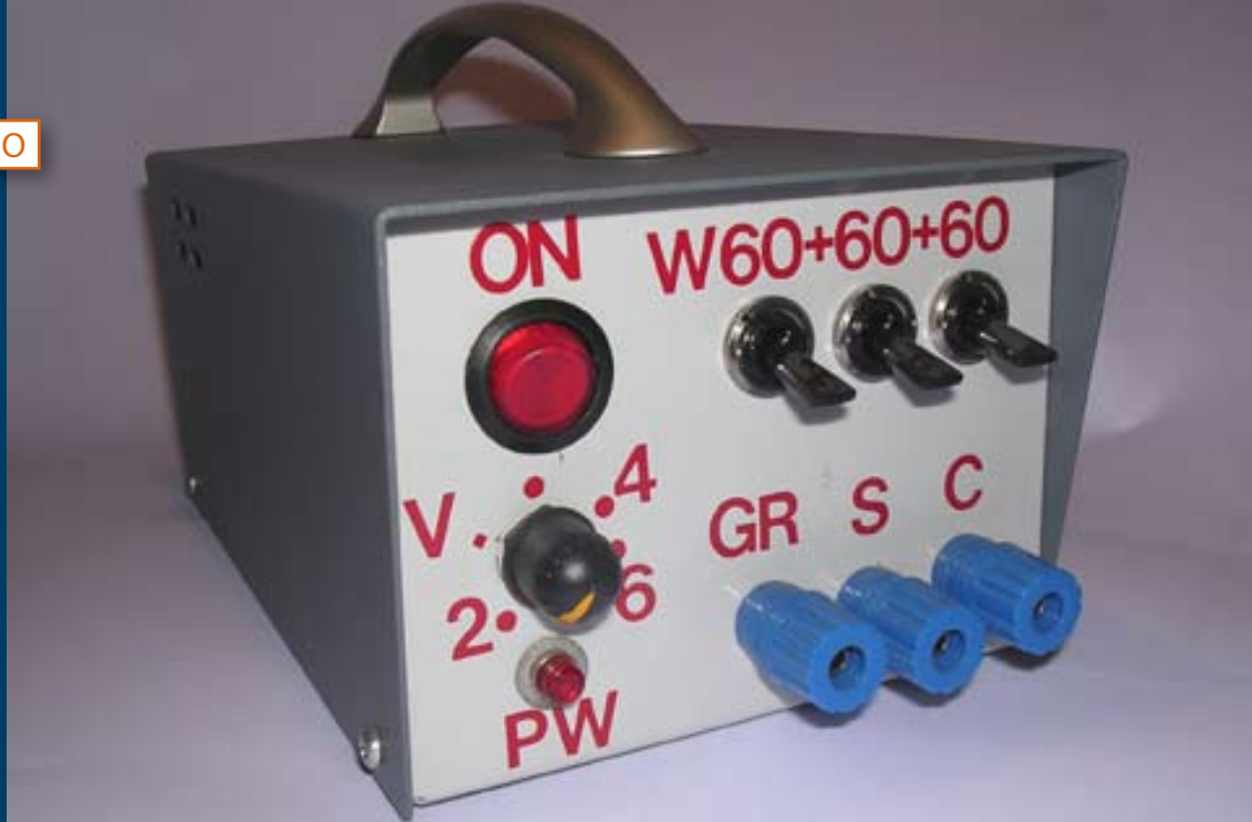
Apparecchiatura per la saldatura a resistenza, vista da fuori...
